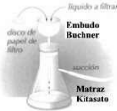
Corte transversal del embudo Buchner.
